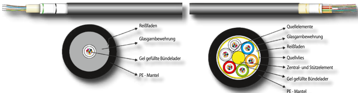
mit zentraler Bündelader bis 24 Fasern
