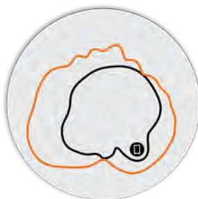
Abbildung 4. R350 2,4 GHz-Elevation-Antennenmuster
