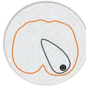
Abbildung 5. R350 5 GHz-Elevation-Antennenmuster
