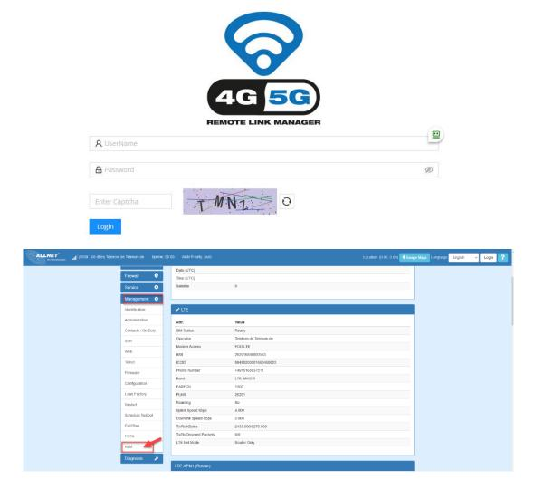
Damit sich die Router an den RLM-Remote-Link Manager verbinden kann, muß im Router unter dem Reiter "Management" "RLM" noch ein paar Einstellungen durchgeführt werden.
